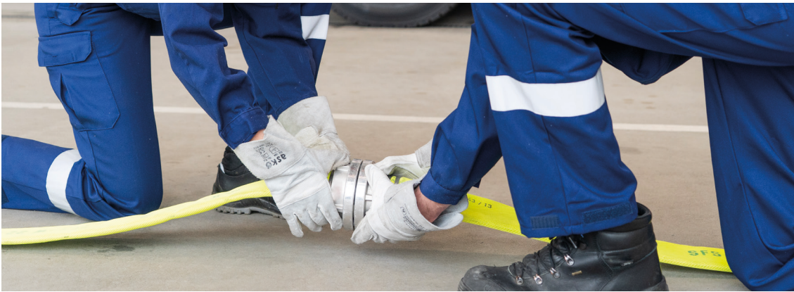
Abb. 4 Kuppeln von Druckschläuchen
